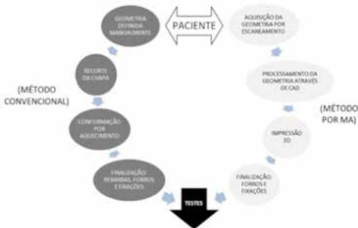
Figura 02: Confeção de órtese pelos métodos convencionais e por MA
