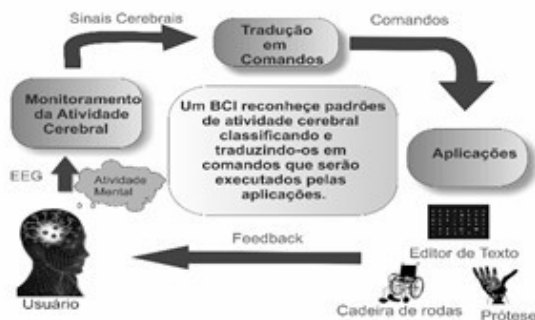
Figura 01: Funcionamento de uma BCI. Fonte: (CARVALHO, 2012)
