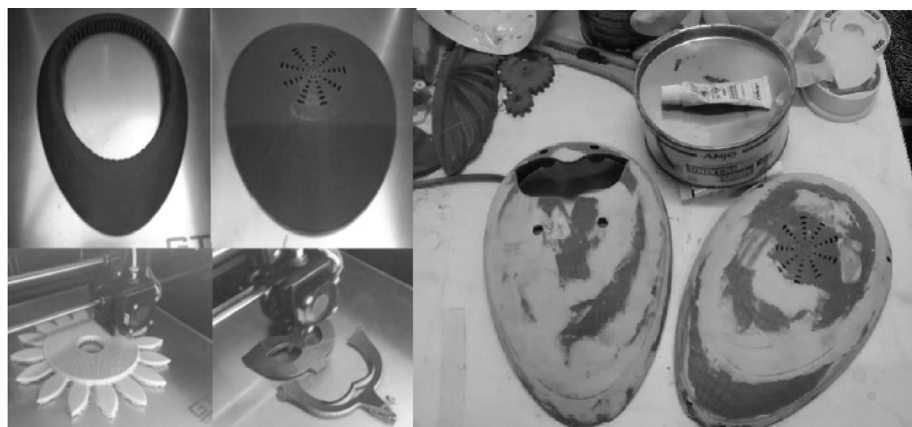
Figura 07 Impressão 3D e acabamento.
