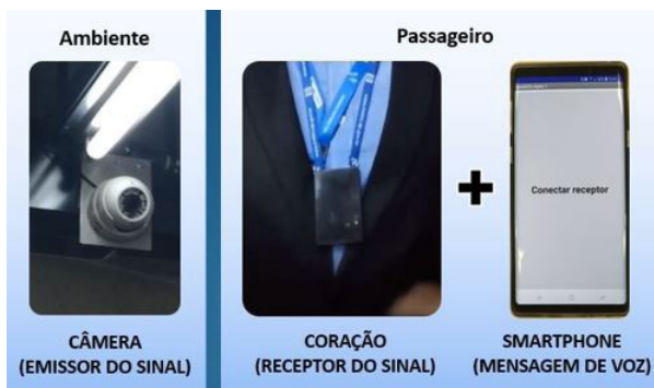
Figura 1 Componentes do sistema NavGATE: câmeras, coração e smartphone
