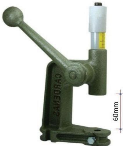
Figura 5. Prensa manual tipo balancim. Fonte: Cardenas (2019)
