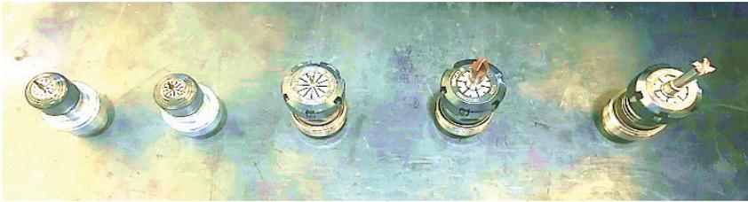
Figura 11. Fresas utilizadas na hsm 500LP. Fonte: Rk Ferramentaria (2018).
