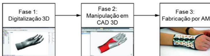
Figura 1. Processo genérico de desenvolvimento de órteses por Manufatura Aditiva, adaptado de Paterson et al. (2014)
