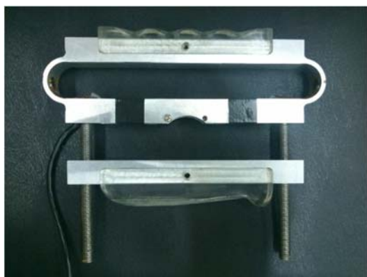
Figura 1: Dinamômetro biomédico em uso neste estudo.
