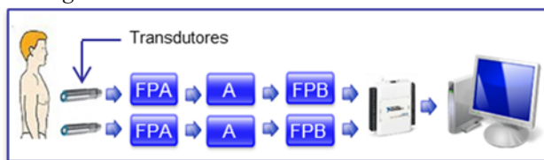
Figura 1: Diagrama em blocos simplificado do instrumento. FPA= filtro passa-altas; A=amplificador e FPB=filtro passa-baixas.
