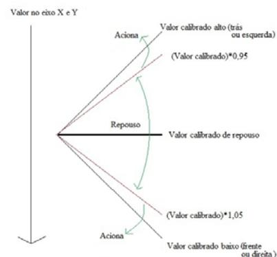
Figura 3: Lógica de acionamento.
