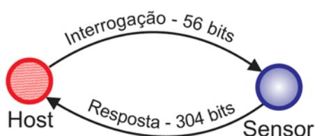
Figura 2 - Processo de leitura dos sensores pelo *host*.
