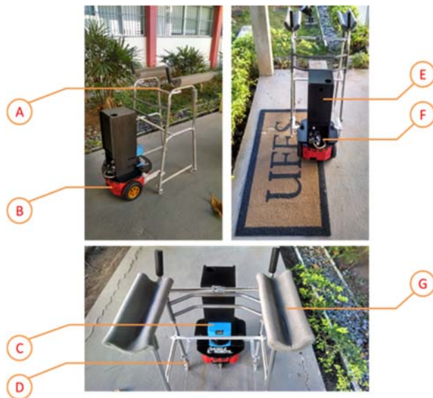
Figura 1 - Detalhes do andador adaptado ao robô Pioneer 3-DX.
