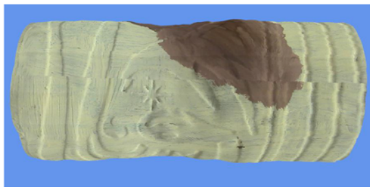
Figura 8: Modelo final, com superfície extraída aplicada à malha de triângulos através do mapeamento de textura.
