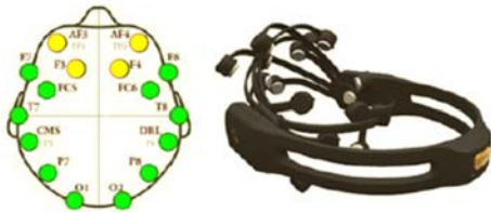
Figura 4: Posicionamento dos eletrodos no escalpo (esquerda). Aparelho Emotiv Epoc Headset (direita).
