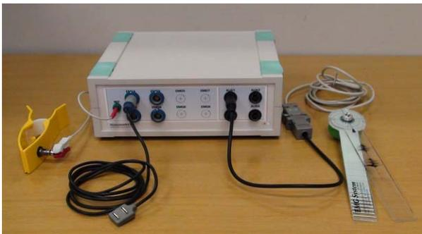
Figura 1: Eletrogoniômetro (à direita) e eletromiógrafo com eletrodo ativo de captação e eletrodo de referência utilizados (à esquerda).
