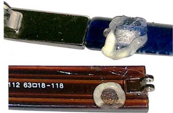
Figura 4: Hastes de policarbonato após o teste de inflamabilidade.
