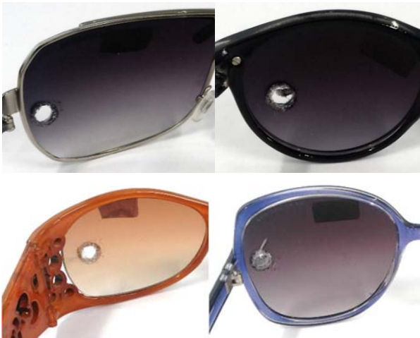
Figura 3: Lentes de policarbonato perfuradas na região de contato da haste aquecida após o teste de inflamabilidade.
