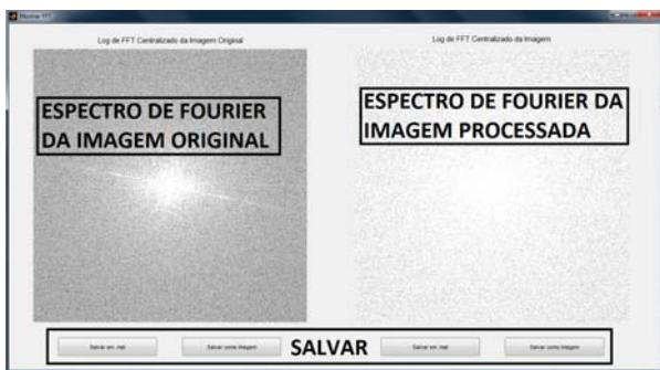
Figura 4: Tela de comparação de transformada de Fourier.
