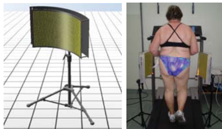
Figura 1: Projeto e Protótipo com LEDs infravermelhos (850nm) durante o exercício em esteira ergométrica.
