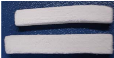
Figura 6: Comparativo da amostra à verde (abaixo) e sinterizada (acima) - liofilizador.
