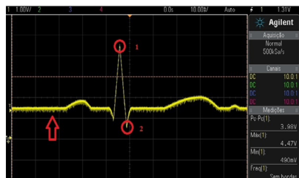
Figura 5: Sinal ECG após amplificação e deslocamento CC automático. (1) Tensão de pico positiva deslocada para 4,47V. (2) Tensão de pico negativa deslocada para 490mV. Escala V.: 500mV/div. Escala H.: 10ms/div.
