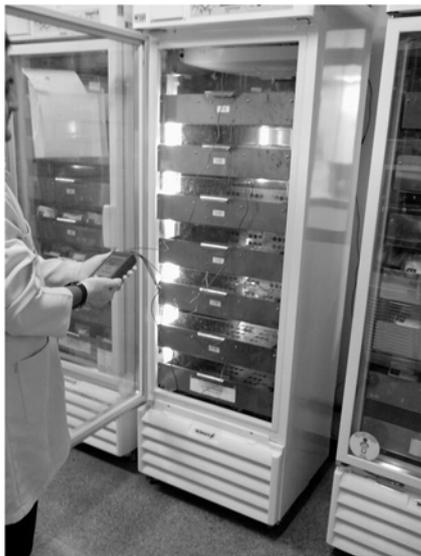
Figura 2: *Setup* do processo de medição das temperaturas das câmaras de conservação com a utilização de datalogger
