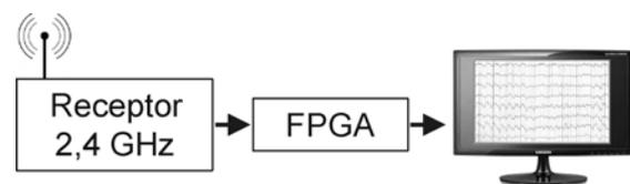
Figura 2 : Diagrama em blocos do módulo receptor.
