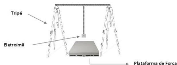
Figura 1. Diagrama do aparato para ensaio mecânico neste trabalho.
