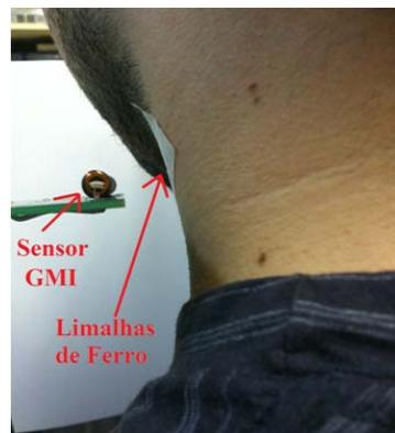
Figura 3: Arranjo experimental implementado para a medição da onda de pulso arterial carotídeo.
