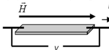
Figura 4: Medição Típica do efeito LMI.
