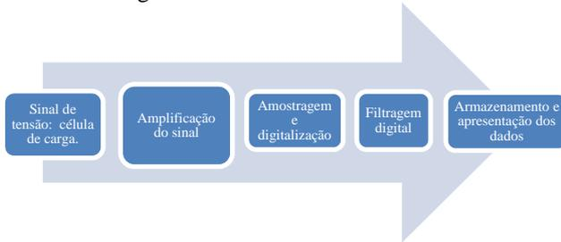
Figura 3: Diagrama de blocos do sistema de aquisição e condicionamento de sinais.
