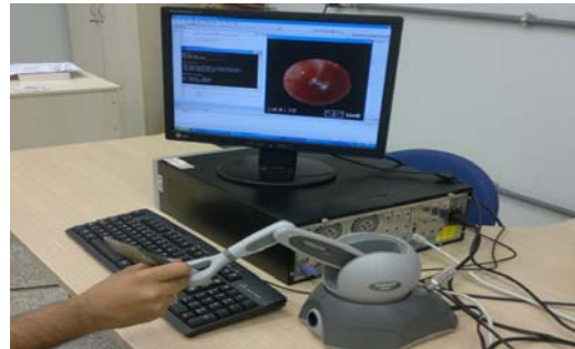
Figura 1 – Simulação (plataforma CHAI 3D) e utilização do dispositivo háptico ( Phantom Omni ® ).
