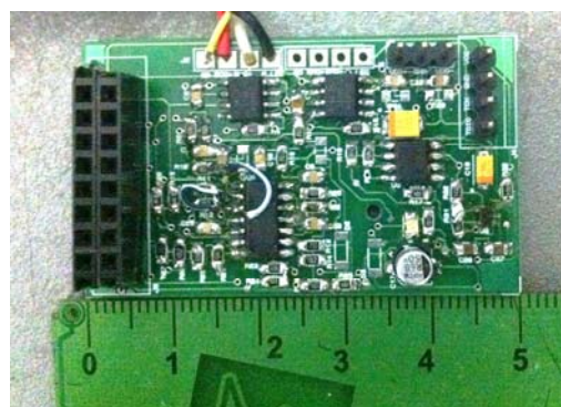
Figura 2: Módulo de Aquisição do sinal de ECG.
