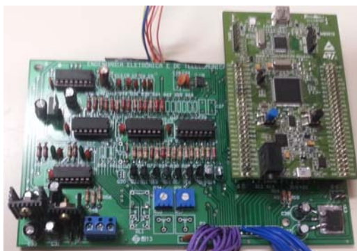
Figura 6: Placas de conformação do sinal (principal) e processamento de dados (canto superior direito).
