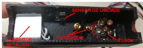
Figura 5: Protótipo da parte de aquisição dos sinais, mostrando os sensores utilizados.
