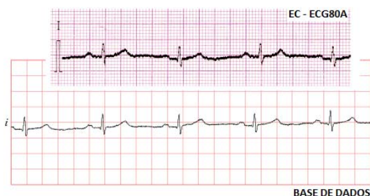
Figura 3: Registro gráfico da derivação DI para o ECG80A comparado com o registro da base de dados.
