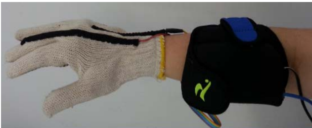
Figura 2: Luva com os sensores Flex e dispositivo com o acelerômetro e circuitos condicionadores de sinal, acoplado no antebraço.
