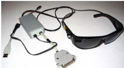
Figura 1: Dispositivo The vOICe [7].
