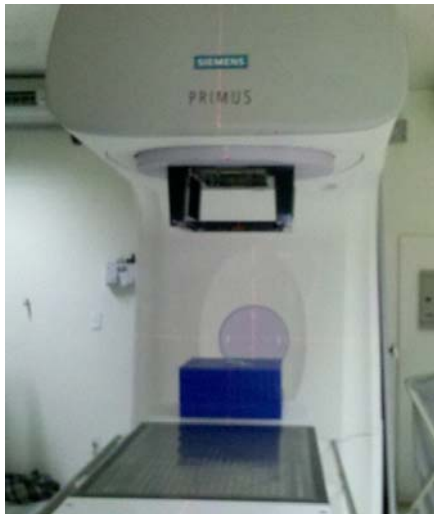
Figura 2: acelerador linear com os dosímetros centralizados no campo de 10 X 10cm.
