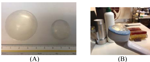
Figura 2: (A) Lentes de silicone; (B) Lente acoplada ao transdutor ultrassônico.
