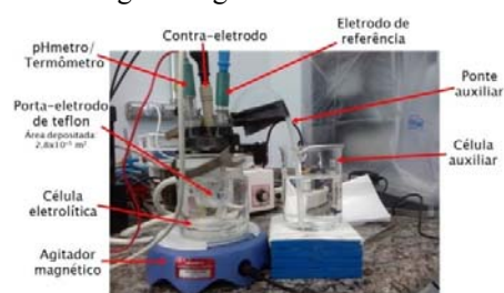
Figura 1- Esquema do processo de eletrodeposição de nHAp, a solução eletrolítica usada na deposição, foi também usada para transporte de íons na ponte.
