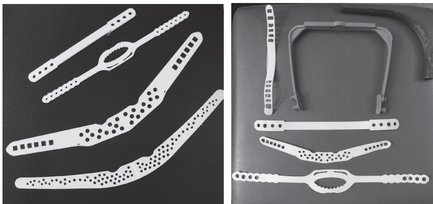
Figura 05; 06 - Foto do modelo de cinta frontal e queixeira em escala reduzida impresso em TPE juntamente dos modelos de cinta occipital em escala real impressos em TPE; Fotos das cintas impressas em TPE, do braço de suspensão impresso em Apex (terpoliéster semiflexível, com carbono) arco ajustável e peça de junção impresso em filamento de fibra de vidro.
