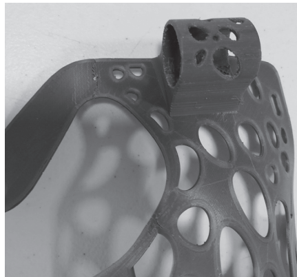
Figura 12 - Órtese impressa em PLA com falhas e ruptura
