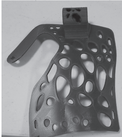
Figura 11 - Órtese impressa em PLA com falhas e ruptura.
