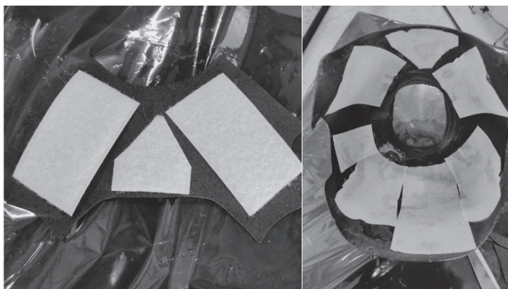
Figura 4 - Posicionamento do velcro no EVA e no capacete
