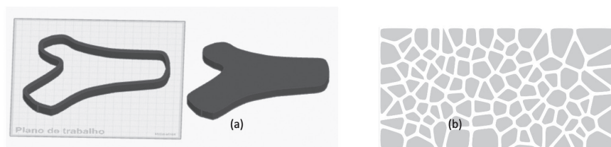
Figura 3 - Padrão Voronoi utilizado para criação da órtese
