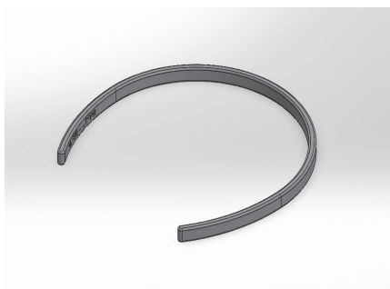
Figura 3 - Concepção final: a) Arco em ABS e b) Encaixe em TPU
