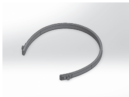
Figura 02 - Concepção inicial: a) Arco em PLA com fibra de carbono e b) Encaixe “Snap-fit circular” impresso em TPU
