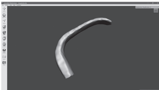
Figura 04 - Exemplo de maçaneta de porta modelada no Meshmixer após escaneamento 3D
