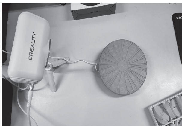
Figura 02 - Escâner CR-Scan Lizard montado no Modo Tabela
