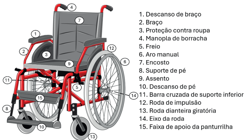
Figura 2 - Indicação de itens tipicamente presentes em cadeiras de rodas.
