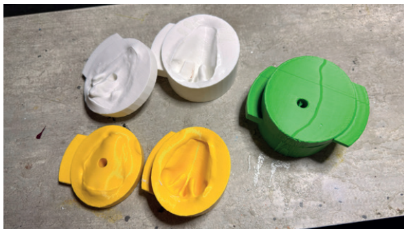
Figura 2 - Moldes produzidos por manufatura aditiva para produção de prótese facial por silicone
