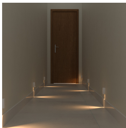
Figura 70. Exemplo de corredor iluminado com balizadores – alternados.
